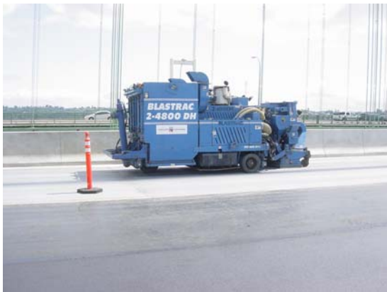
Figure 3. Blastrac 2-4800 DH shotblaster.
