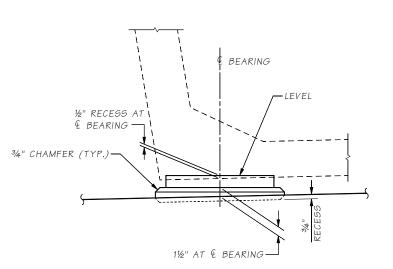
GROUT PAD ELEVATION
